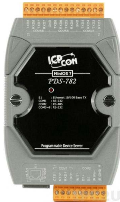
Рисунок 3. Сервер последовательных интерфейсов PDS-782
