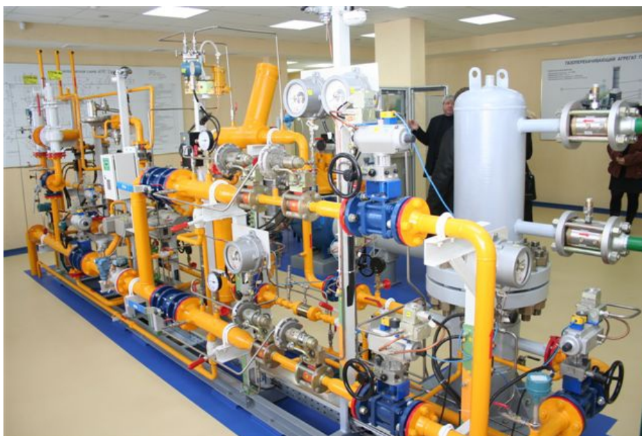
Учебный тренажер ГРС в учебном центре ООО «Газпром трансгаз Уфа»
