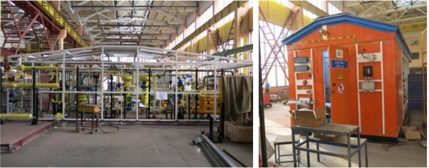
*Сборка блочно-модульного нефтегазового оборудования*
