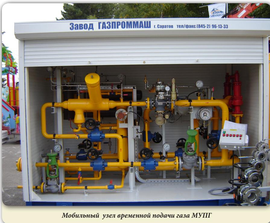
Учитывая максимальную заводскую готовность рассматриваемого оборудования, такой ремонт при использовании мобильного узла для временной подачи газа (МУПГ) производства завода «Газпроммаш» можно выполнить в кратчайшие сроки без прекращения подачи газа потребителю.
