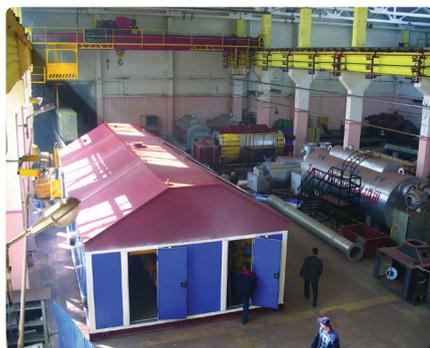
*Состыковка блок-модулей ГРПБ-150 в заводских условиях*
