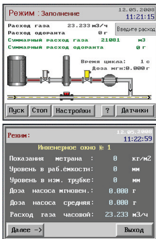
Рисунок 3. Примеры отображения экранов панели БУО-02
