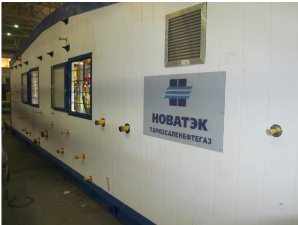
Блок подготовки газа для Восточно-Таркосалинского НГКМ
